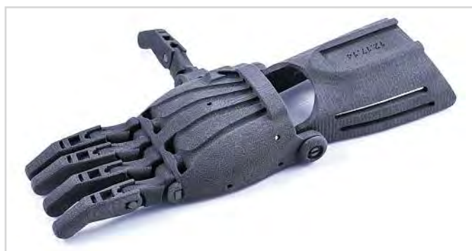
Prothèse de main d'enfant fabriquée sur la machine S1.
