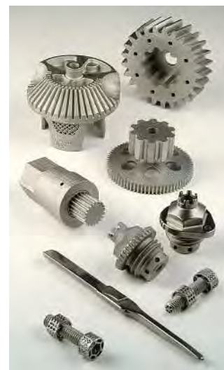
La projection de liant permet de réaliser des pièces complexes.
