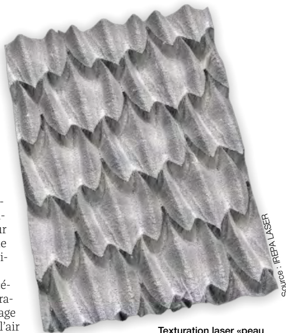
Texturation laser «peau de requin» sur aluminium.
