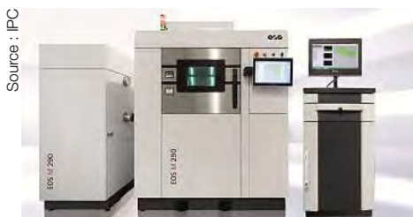
Le système de tomographie OT Monitoring équipe l'imprimante M290 d'EOS.
